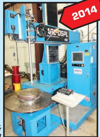
ARC SPECIALTIES MDL. ARC-05PL VERT. COMPACT BORE CLADDING SYSTEM
