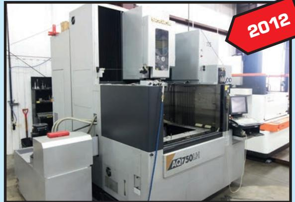
SODICK MDL. AQ750LH WIRE EDM MACHINE
