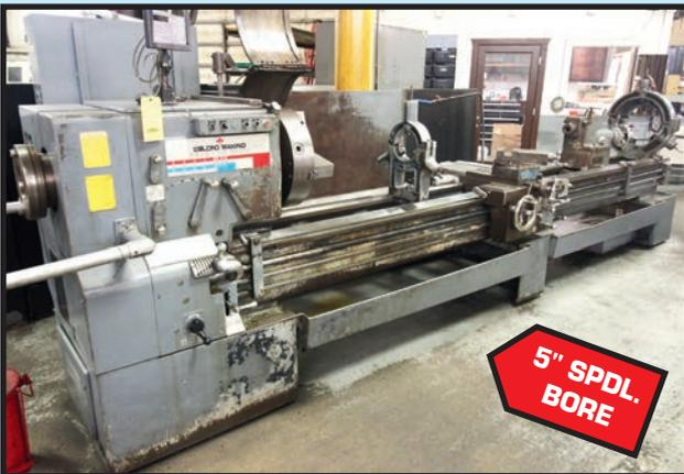
25" X 120" LEBLOND MAKINO HOLLOW SPINDLE MDL. 26/5-HS REGAL LATHE
