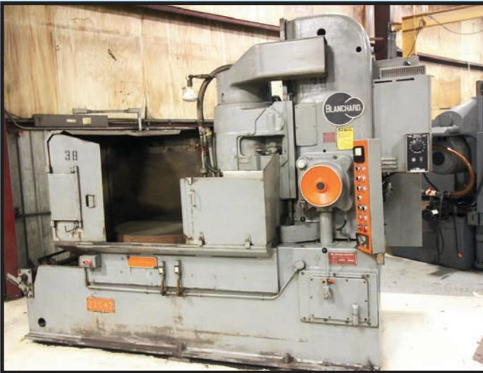
**BLANCHARD MDL. 22K42 ROTARY SURFACE GRINDER**
